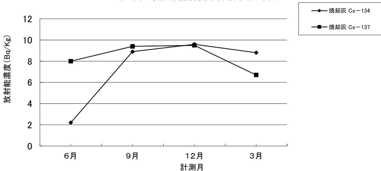
焼却灰等放射能濃度分析結果(飛灰固化物)
